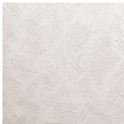
ノワ 木ゴテでクロス柄を引き、金ゴテで表面を押さえた仕上げ。 仕上厚：3mm
