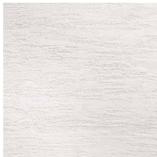
フレスコ 木ゴテで横引き模様をつけ、金ゴテで表面を押さえた仕上げ。 仕上厚：3mm
